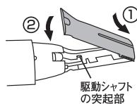
2) 駆動シャフトの突起部と刃部の穴の位置がずれてはまりにくい時は、スイッチをONにして駆動シャフトの突起部の位置を動かして合わせてください。
