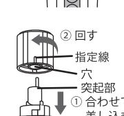
2 刃台と本体の指定線を合わせ「カチッ」と音がするまで矢印方向(左)の印に合うように取り付けてください。
