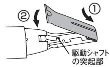
2) 駆動シャフトの突起部と刃部の穴の位置がずれています。また、スイッチをONにして駆動シャフトの突起部の位置を動かして合わせてください。
